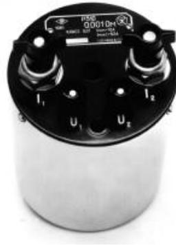
Предназначены для работы в цепях постоянного тока в качестве однозначных мер электрического сопротивления классов точности 0,01 и 0,02.
